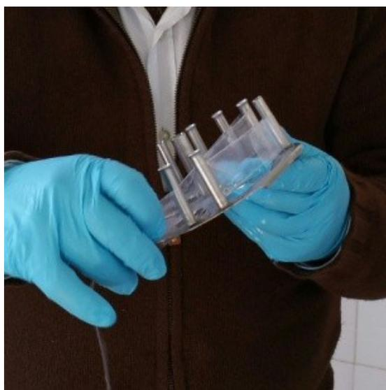
Figura 5.3 – Amostrador de Hidrocarbonetos Aromáticos Polinucleares (PAH) (Morais, 2016)
