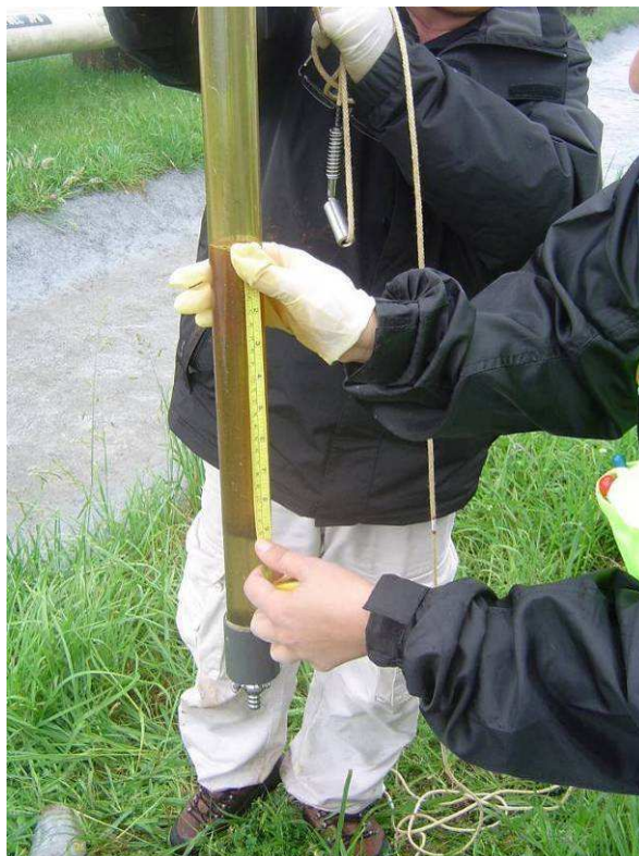
Fig. 38 – Fotografia de LNAPL sobrenadante na água do ponto MW08
