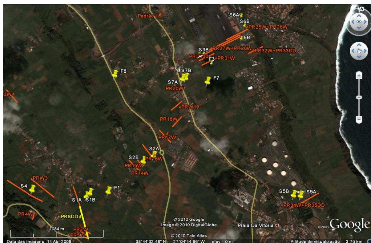
Figura A2.1 - Imagem do Google com implantação de alguns dos perfis executados e dos locais seleccionados para execução dos furos de sondagem para amostragem de solos (S1A a S7B) e dos furos para o estudo hidrogeológico (F1 a F8 – F2 coincide com S2A; F4 não foi marcado e F5 encontra-se sobreposto com a marca do furo S5A).
