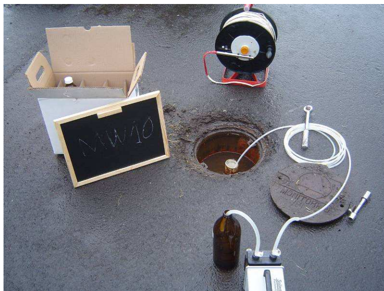
Fig. 37 – Recolha de amostra com recurso a uma bomba peristáltica de baixo caudal
