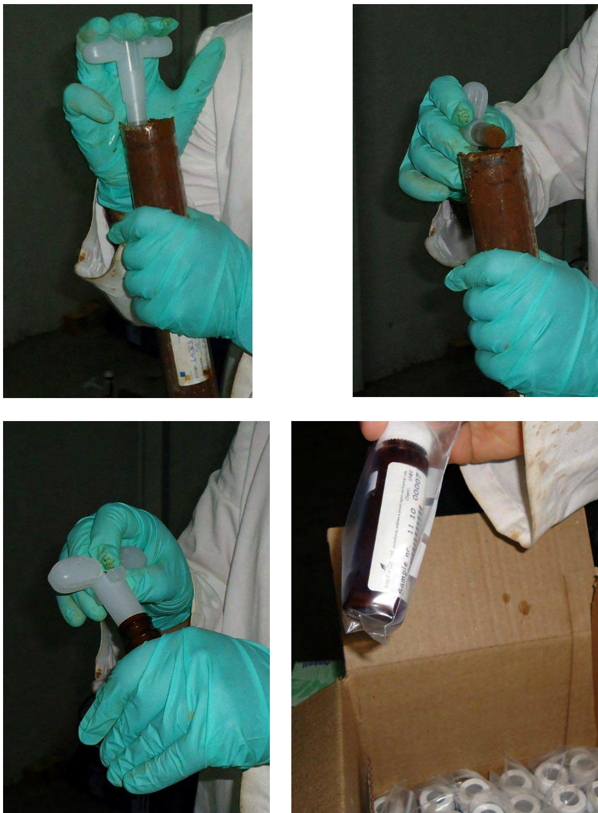
Figura 41 – Preparação de amostra com TerraCore, colocação da amostra em metanol e acondicionamento do Via /para envio.
