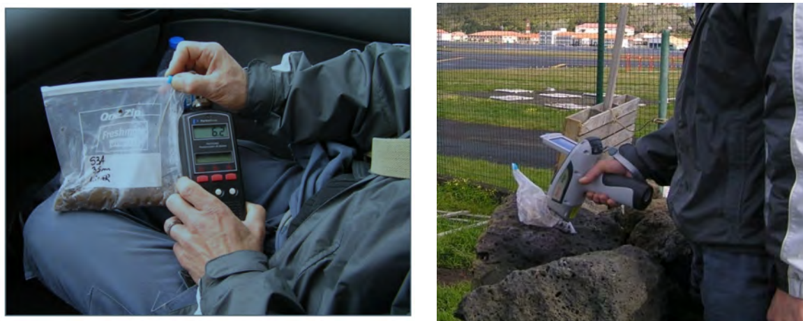
Figura 20 – Realização das determinações on site por Multi-Pid e por FRX (imagens retiradas de [7]).
