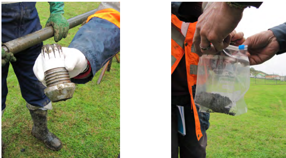
Figura 19 – Cabeça do amostrador e aproveitamento do respectivo solo para ensaios on site .
