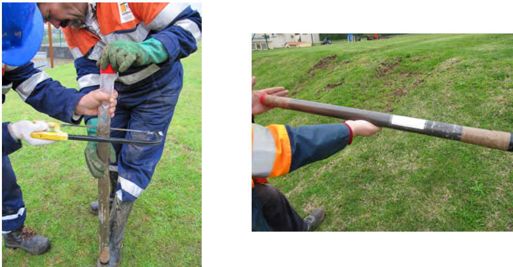
Figura 18 – Preparação da amostra e amostra final pronta a acondicionar no frio.
