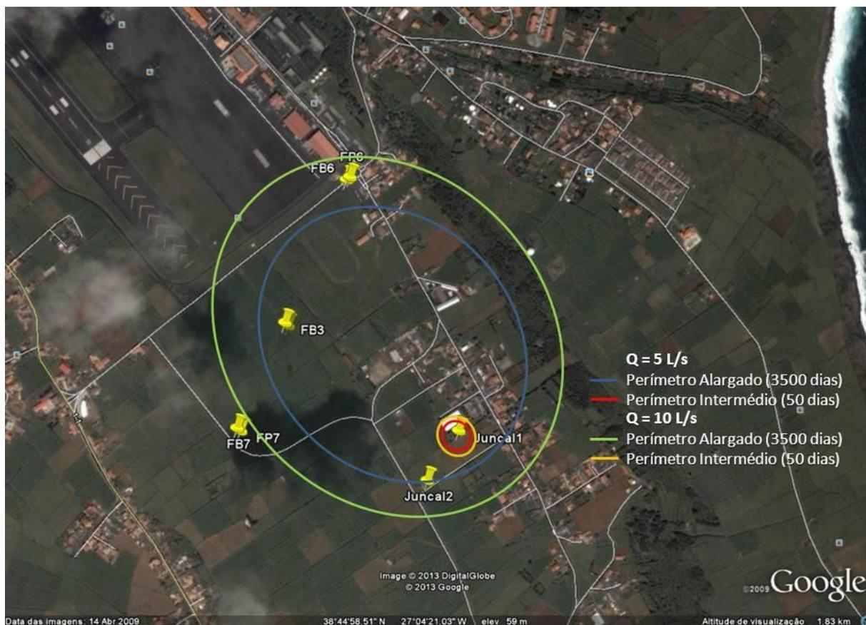
Figura 7.10 - Perímetro de proteção Intermédio e Alargado para a captação Juncal 1, considerando os caudais de extração de 5 L/s e 10 L/s (extraída de Henriques *et al.*, 2013)
