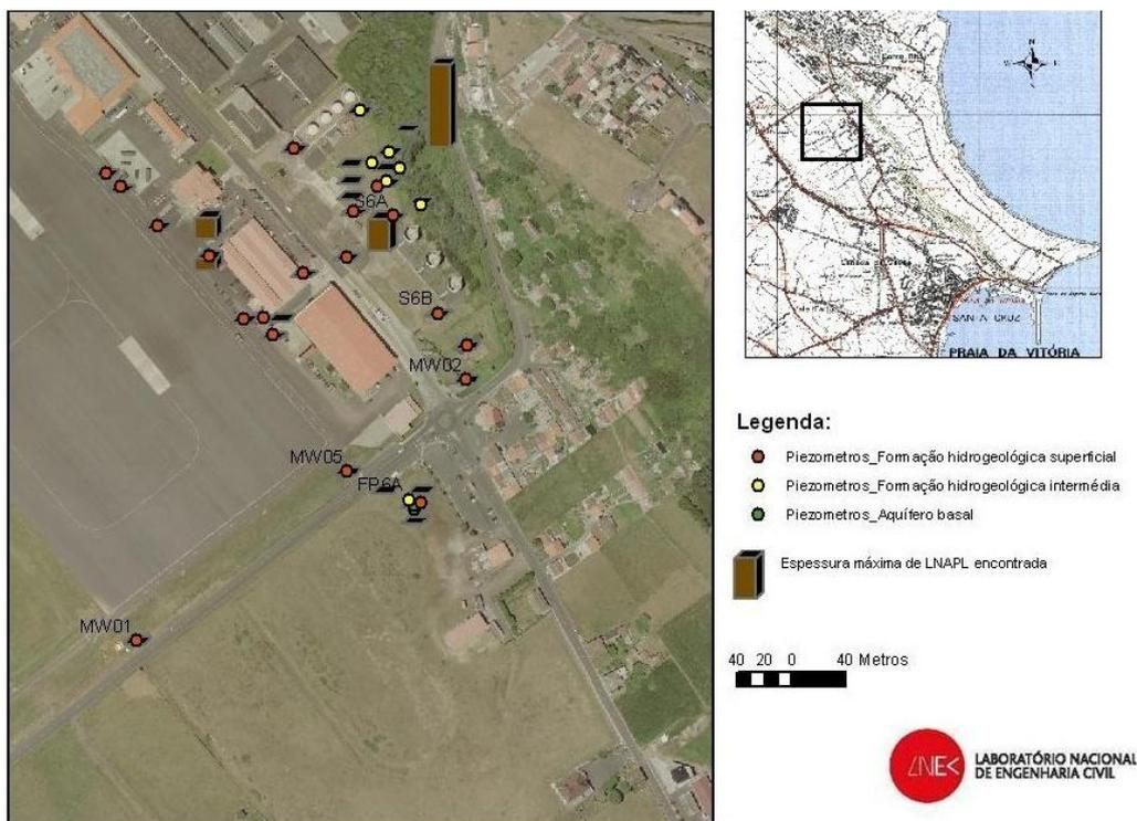
**Figura 4.1 - Espessura máxima de LNAPL em piezómetros localizados nas formações hidrogeológicas superficial e intermédia no Site 3001**
