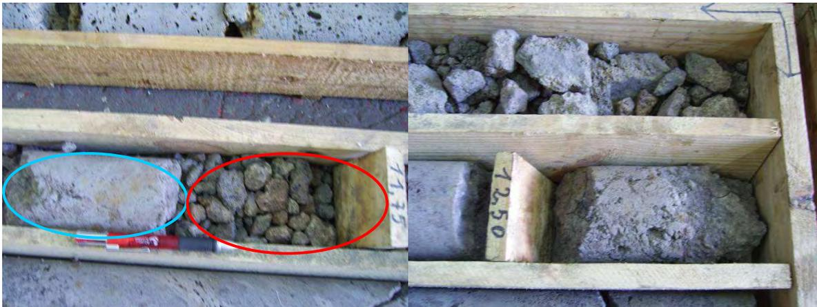
Fig. 120 – Brecha basáltica do troço 1 (à esquerda, círculo vermelho), traquibasalto do troço 2 (à esquerda, círculo azul) e traquibasalto poroso do troço 4 (à direita) da secção dos 11,75 a 12,50 m de profundidade
