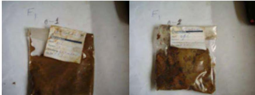
Fig. 1 – Amostra representativa das profundidades 0 a 1 m (à esquerda) e 1 a 2 m (à direita)
