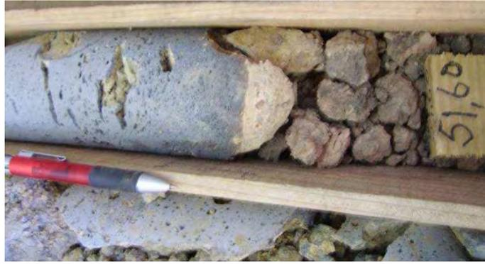
Fig. 55 – Argila do troço 4 da secção dos 50,00 a 51,60 m de profundidade
