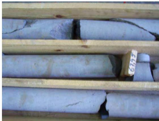
Fig. 64 – Traquibasalto da secção dos 65,55 a 67,95 m de profundidade
