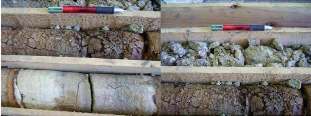
Fig. 57 – Traquibasalto com macroporos do troço 1 (em cima) e argilas do troço 2 (em baixo) da secção dos 51,60 a 54,15 m de profundidade
