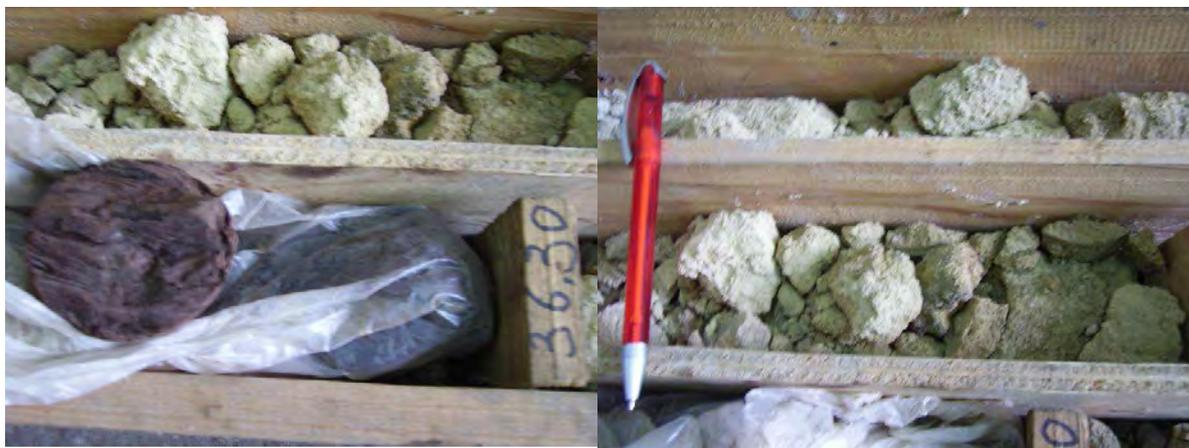
Fig. 108 – Madeira recolhida na secção dos 33,00 a 36,30 m de profundidade (à esquerda) e arenito argiloso/argilito arenoso da secção dos 36,30 a 39,30 m de profundidade (à direita)
