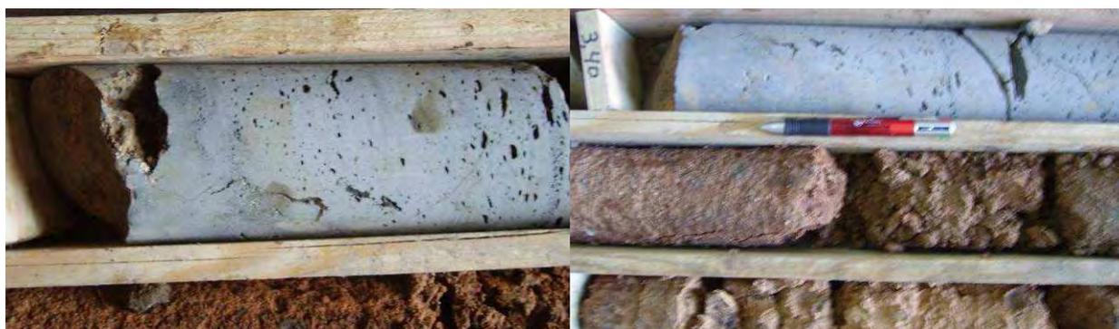
Fig. 114 – Traquibasalto do troço 2 da secção dos 2,65 a 3,40 m de profundidade
