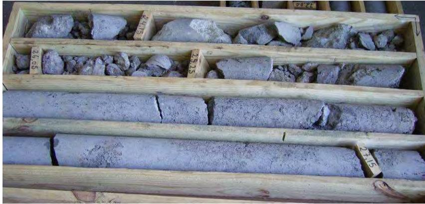
Fig. 131 – Conjunto das litologias atravessadas – 6º tabuleiro (profundidade final = 28,65 m)
