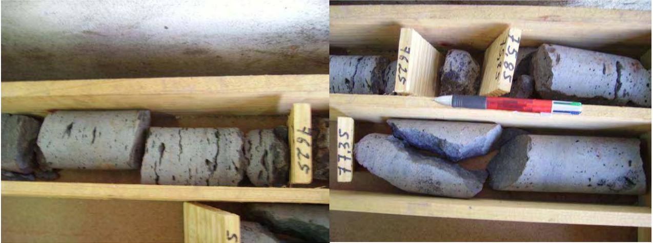
Fig. 69 – Traquibasilto poroso do troço inicial (à esquerda) e muito pouco poroso do troço final (à direita) da secção dos 76,25 a 77,35 m de profundidade
