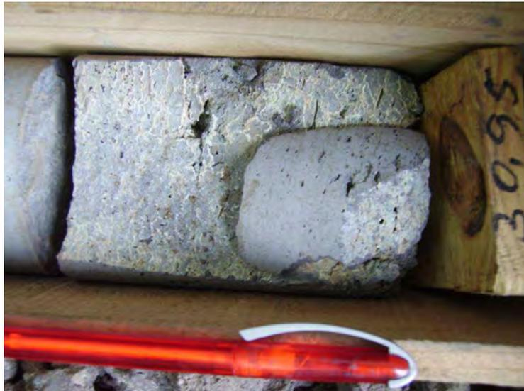
Fig. 49 – Depósitos de alteração do traquibasalto da secção dos 29,85 a 30,95 m de profundidade
