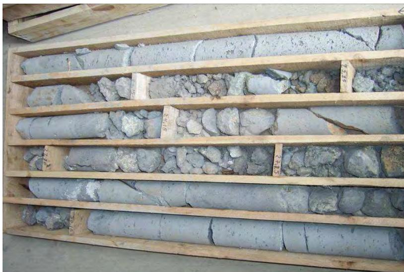
Fig. 12 – Conjunto das litologias atravessadas – 3º tabuleiro (profundidade final = 30,15 m)
