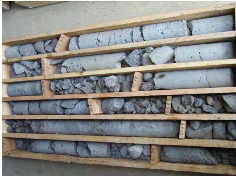
Fig. 23 – Conjunto das litologias atravessadas – 9º tabuleiro (profundidade final = 67,00 m)
