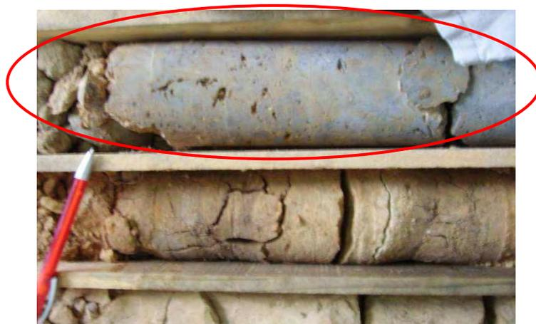
Fig. 103 – Traquibasalto (círculo vermelho) da secção dos 54,25 a 55,15 m de profundidade
