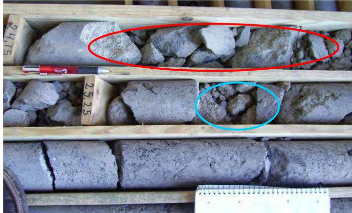
Fig. 129 – Traquibasalto fracturado da secção dos 23,50 a 24,15 m de profundidade (círculo vermelho) e traquibasalto com zonas totalmente fragmentadas da secção dos 24,15 a 25,25 m de profundidade (círculo azul)
