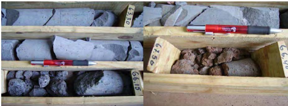
Fig. 148 – Brecha da secção dos 66,15 a 66,40 m de profundidade e brecha da secção dos 66,40 a 67,50 m de profundidade
