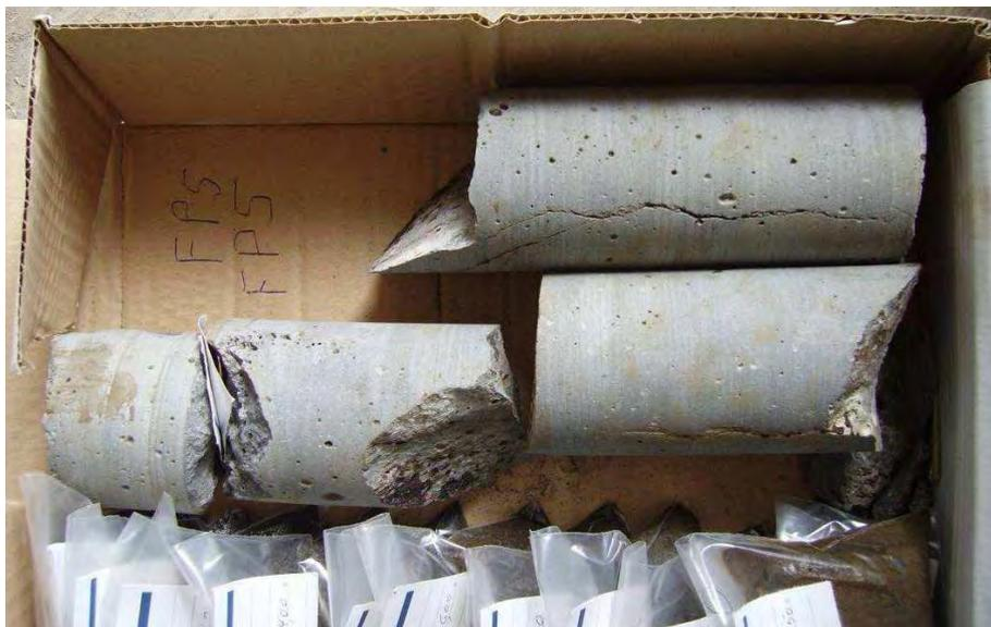
Fig. 88 – Conjunto das litologias atravessadas – 1º e único tabuleiro (profundidade final = 12 m)
