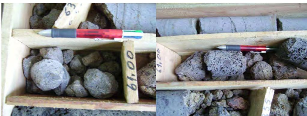
Fig. 61 – Bombas arredondadas da secção dos 59,75 a 61,00 m de profundidade; Brecha da secção dos 61,00 a 61,65 m de profundidade
