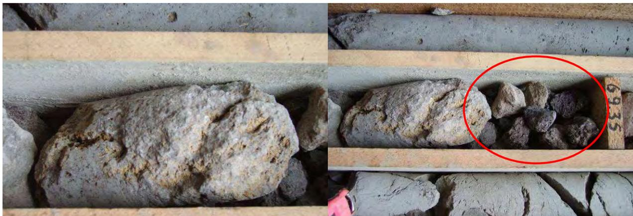
Fig. 24 – Material desagregado tipo “brecha” do troço 1 (à direita; círculo vermelho) e material traquibasáltico com depósitos amarelados de alteração do troço 2 (à esquerda) da secção dos 69,35 a 70,95 m de profundidade
