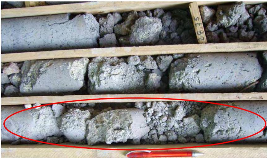
Fig. 48 – Brechas intercaladas em traquibasaltos da secção dos 25,30 a 26,55 m de profundidade
