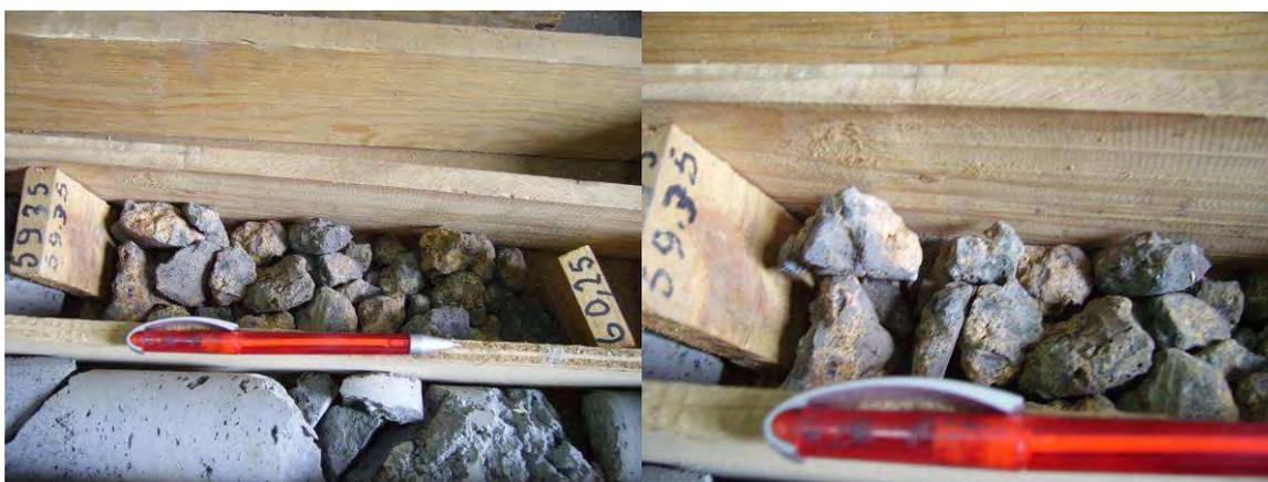
Fig. 80 – Brecha da secção dos 59,35 a 60,25 m de profundidade
