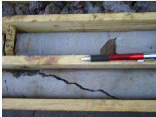
Fig. 144 – Fractura em traquibasalto pouco poroso da secção dos 56,20 a 57,15 m de profundidade
