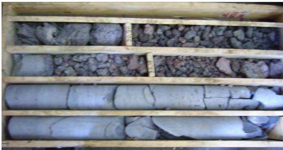
Fig. 134 – Conjunto das litologias atravessadas – 7º tabuleiro (profundidade final = 31,70 m)
