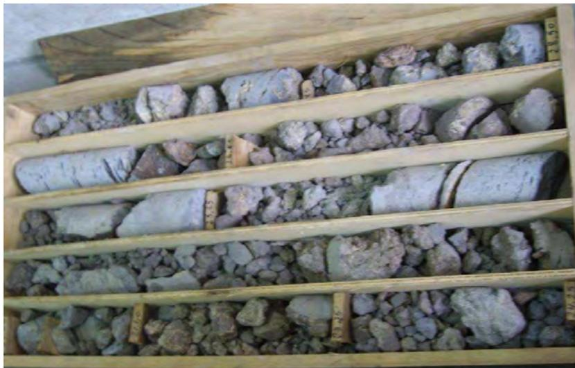
Fig. 73 – Conjunto das litologias atravessadas – 1º tabuleiro (profundidade final = 28,50 m)
