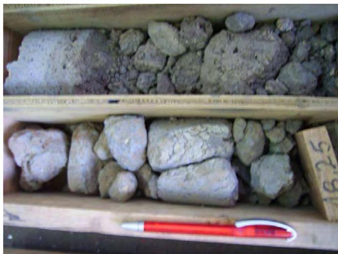
Fig. 44 – Brechas e fragmentos de bombas da secção dos 18,00 a 18,25 m de profundidade
