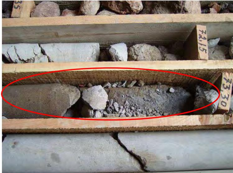
Fig. 25 – Material lávico fracturado e húmido do troço 1 (círculo vermelho) da secção dos 73,30 a 75,15 m de profundidade
