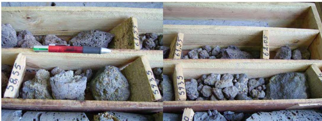
Fig. 60 – Brecha da secção dos 58,55 a 59,35 m de profundidade (à esquerda); Brecha da secção dos 59,35 a 59,75 m de profundidade (à direita)
