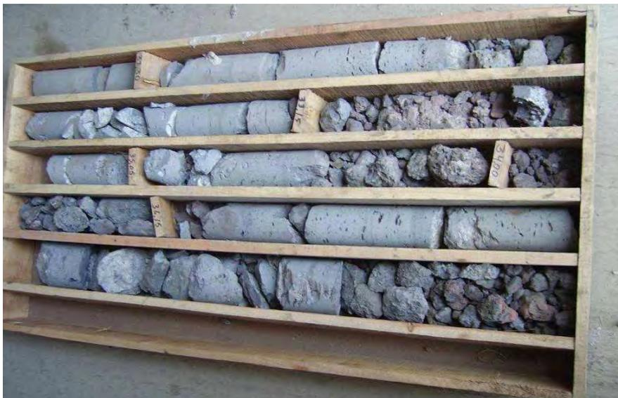
Fig. 13 – Conjunto das litologias atravessadas – 4º tabuleiro (profundidade final = 37,70 m)
