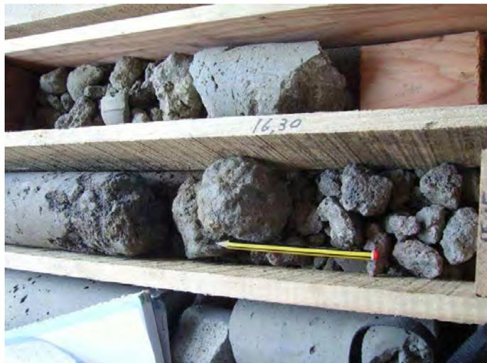
Fig. 7 – Brecha do troço 6 da secção dos 13,10 a 15,15 m; destaque para o troço 6 (material desagregado)
