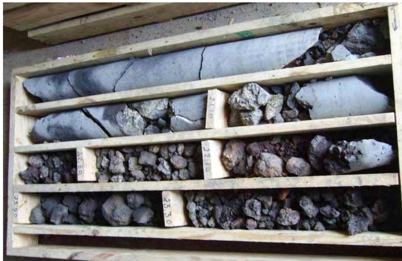
Fig. 128 – Conjunto das litologias atravessadas – 5º tabuleiro (profundidade final = 23,50 m)
