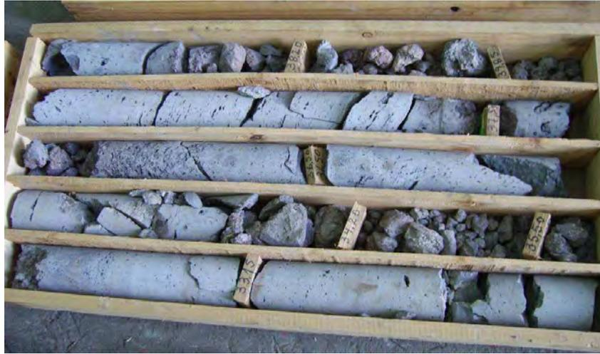
Fig. 51 – Conjunto das litologias atravessadas – 3º tabuleiro (profundidade final = 40,00 m)
