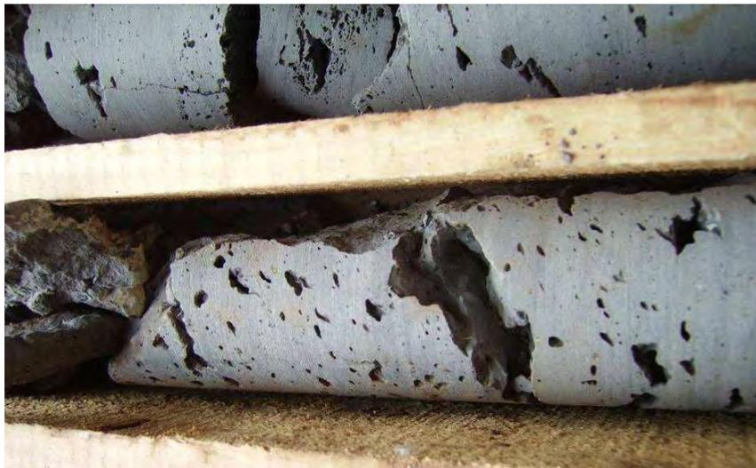
Fig. 20 – Macroporos do troço 2 da secção dos 54,11 a 55,65 m de profundidade
