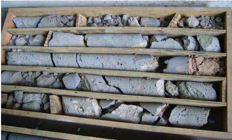
Fig. 47 – Conjunto das litologias atravessadas – 1º tabuleiro (profundidade final = 25,30 m)
