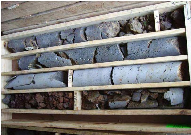
Fig. 119 – Conjunto das litologias atravessadas – 2º tabuleiro (profundidade final = 10,00 m)
