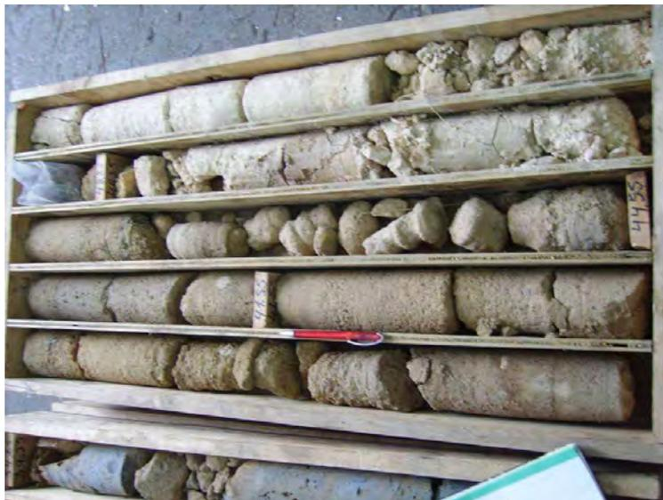
Fig. 100 – Conjunto das litologias atravessadas – 2º tabuleiro (profundidade final = 50,00 m)
