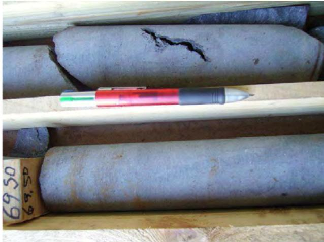
Fig. 66 – Traquibasalto da secção dos 69,50 a 72,00 m de profundidade
