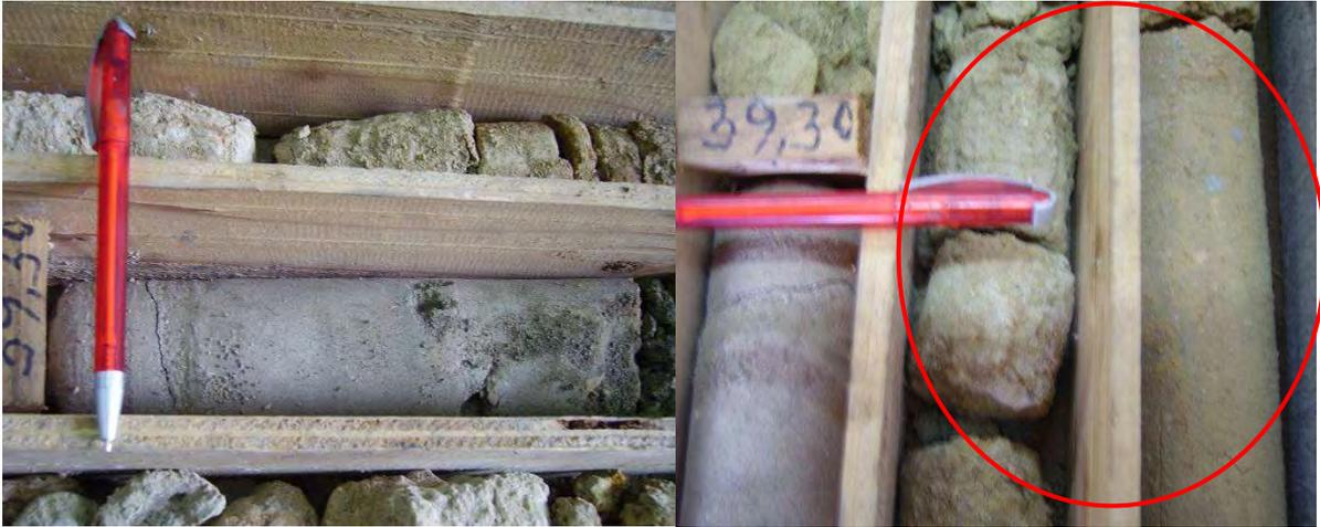
Fig. 109 – Argila arenosa do troço 1 (à esquerda) e argilito arenoso do troço 3 (à direita, círculo vermelho) da secção dos 39,30 a 42,00 m de profundidade
