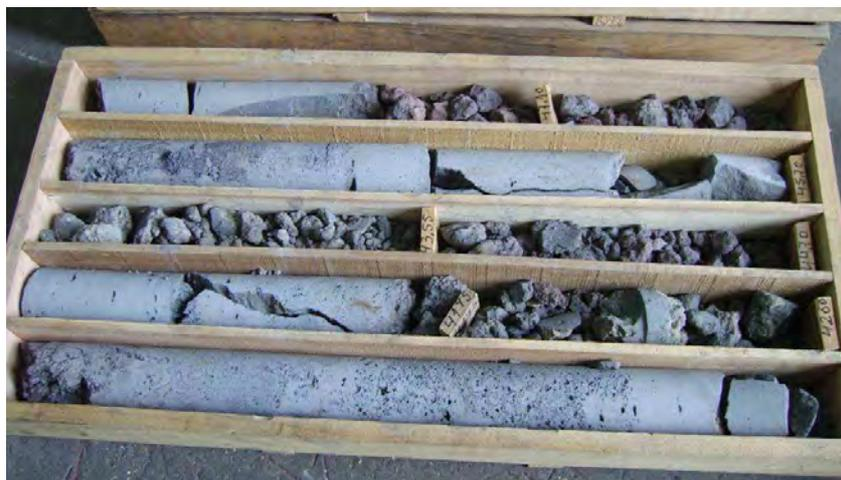
Fig. 53 – Conjunto das litologias atravessadas – 4º tabuleiro (profundidade final = 47,50 m)
