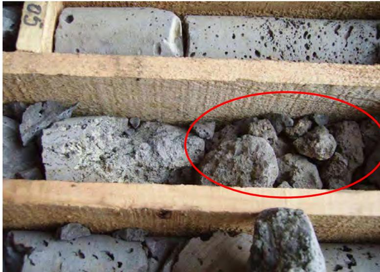
Fig. 18 – Zona de brecha (círculo vermelho) do troço 1 da secção dos 52,90 a 53,80 m de profundidade, na zona de contacto com o material lávico muito fracturado (sito à esquerda do círculo)
