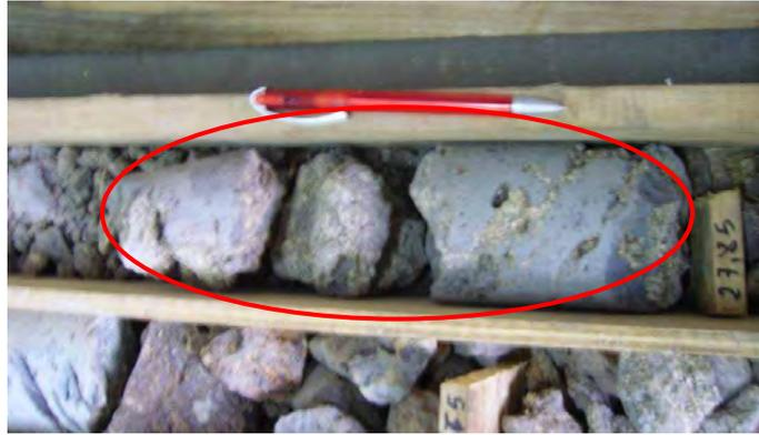
Fig. 72 – Traquibasalto muito fracturado e depósitos de alteração nos poros e fracturas do troço 2 da secção dos 26,65 a 27,85 m de profundidade
