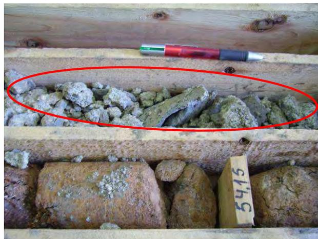
Fig. 58 – Brecha de traquibasalto muito alterado (círculo vermelho) do troço 2 da secção dos 54,15 a 55,30 m de profundidade
