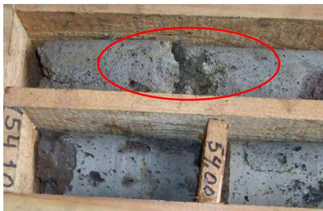
Fig. 17 – Macroporo à secção dos 52,05 a 52,90 m de profundidade
