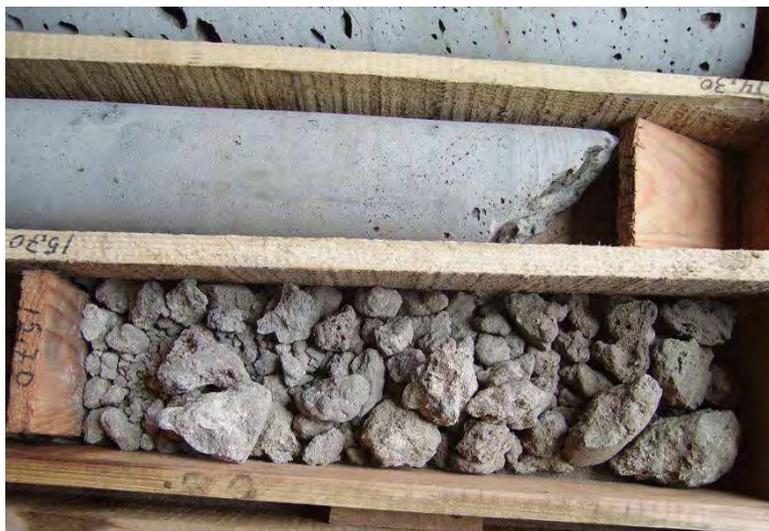
Fig. 8 – Brecha da secção dos 15,15 a 15,70 m de profundidade
