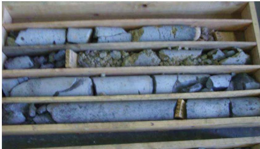
Fig. 56 – Conjunto das litologias atravessadas – 5º tabuleiro (profundidade final = 51,60 m)
