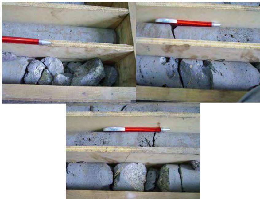
Fig. 76 – Traquibasalto da secção dos 41,00 a 43,95 m de profundidade
