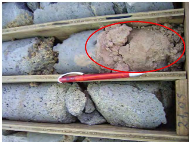
Fig. 46 – Nível de argila arenosa do troço 2 da secção dos 21,05 a 23,15 m de profundidade
