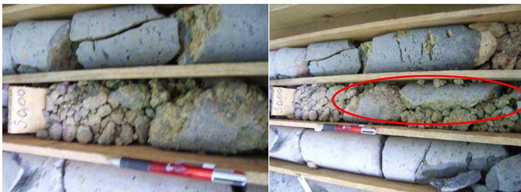
Fig. 54 – Brecha do troço 1 (à esquerda) e traquibasilto ruiniforme (à direita; círculo vermelho) do troço 2 da secção dos 50,00 a 51,60 m de profundidade
