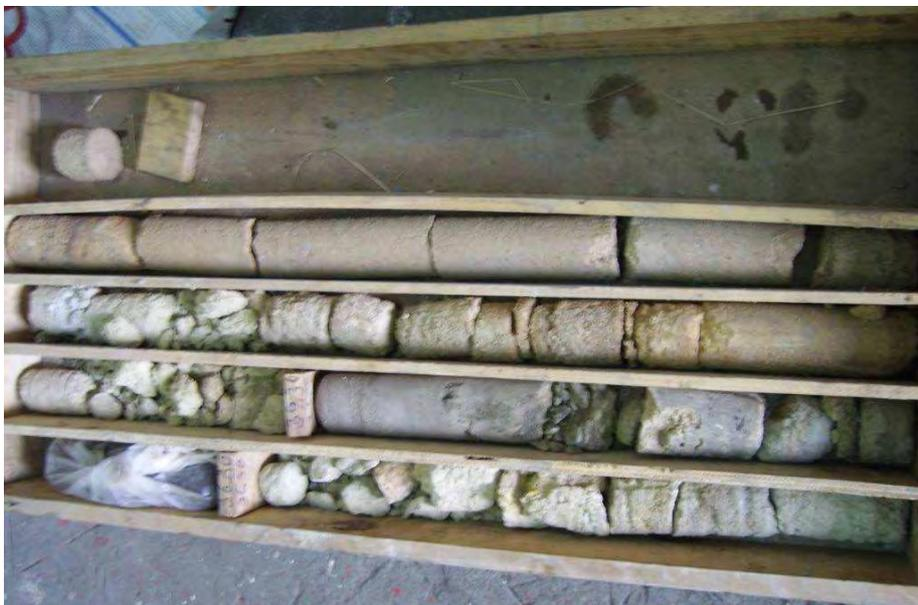
Fig. 110 – Conjunto das litologias atravessadas – 1º tabuleiro (profundidade final = 42,00 m)
