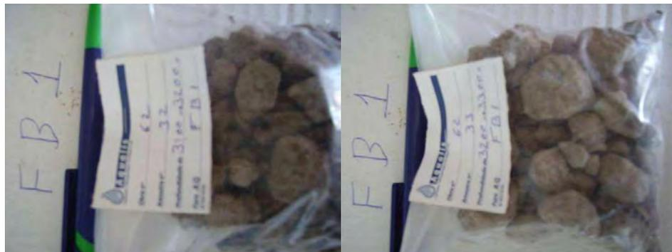
Fig. 43 – Amostra representativa das profundidades 31 a 32 m (à esquerda) e 32 a 33 m (à direita)
