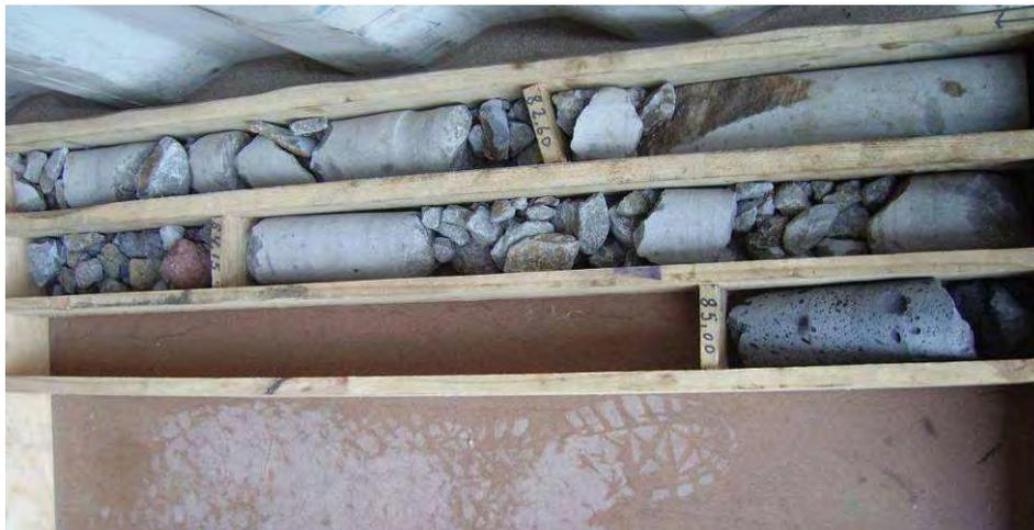
Fig. 30 – Conjunto das litologias atravessadas – 12º tabuleiro (profundidade final = 85,00 m)
