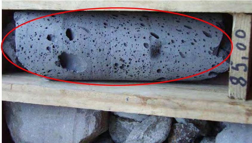
Fig. 29 – Material lávico poroso, com megaporos, do troço 2 (círculo vermelho) da secção dos 84,15 a 85,00 m de profundidade
