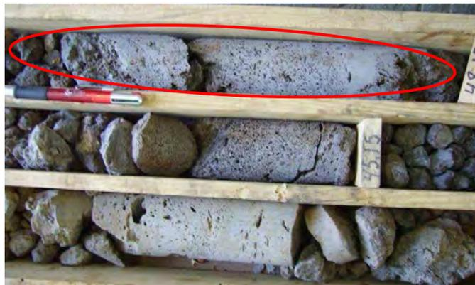
Fig. 141 – Brechas da secção dos 42,15 a 45,15 m de profundidade e brechas e nível de lavas da secção dos 46,70 a 48,15 m de profundidade (círculo vermelho)
