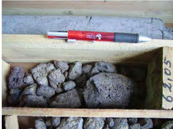
Fig. 62 – Brecha da secção dos 61,55 a 62,05 m de profundidade
