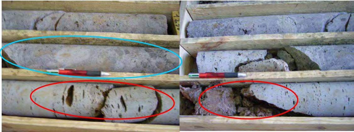
Fig. 121 – Traquibasalto do troço 1 (à esquerda, círculo azul zona pouco porosa; círculo vermelho zona com megaporos) e argila do troço 2 (à direita, círculo vermelho) da secção dos 12,50 a 15,15 m de profundidade
