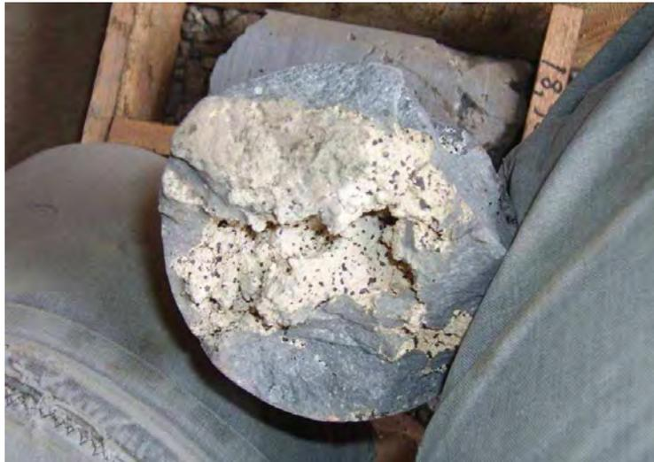
Fig. 10 – Macroporo ao troço 3 da secção dos 16,30 a 17,30 m de profundidade
