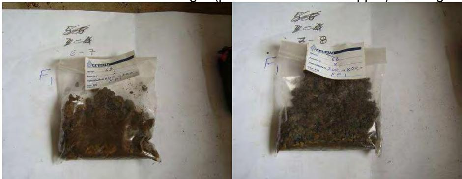
Fig. 4 – Amostra representativa das profundidades 6 a 7 m (à esquerda) e 7 a 8 m (à direita)
