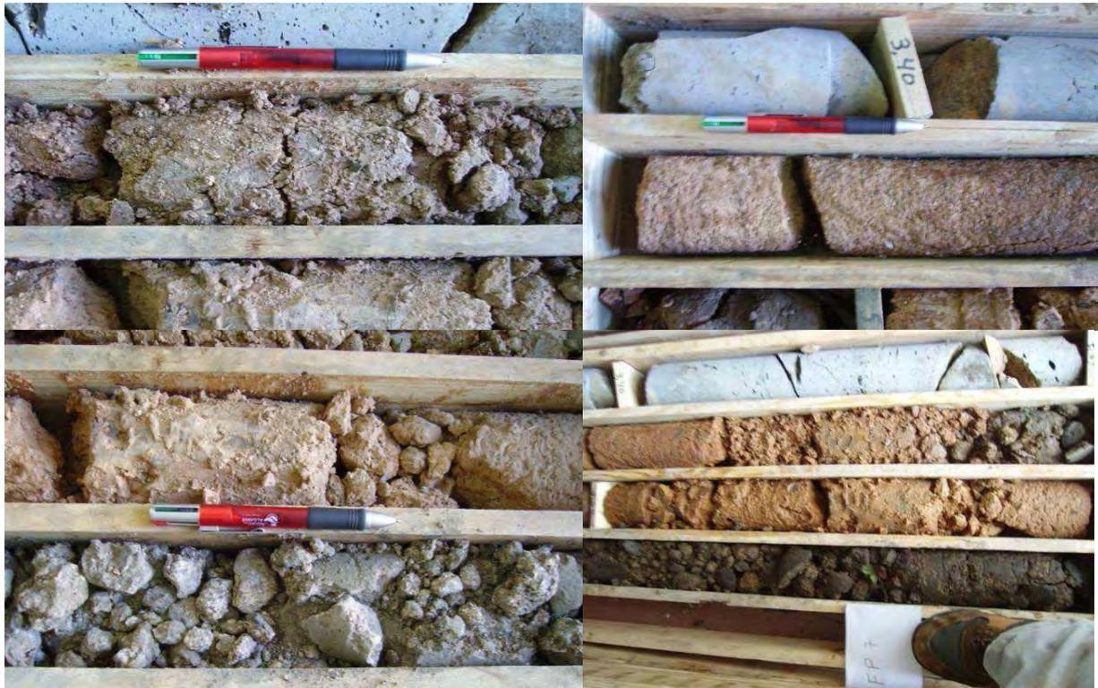
Fig. 115 – Argila arenosa com fendas de retracção (à esquerda em cima), argila arenosa/areia argilosa (à direita em cima), argila com menor componente arenosa (em baixo) do troço 3 da secção dos 3,40 a 5,50 m de profundidade
