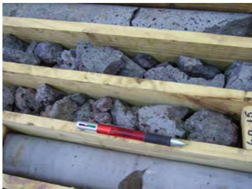
Fig. 145 – Brecha da secção dos 58,90 a 60,15 m de profundidade
