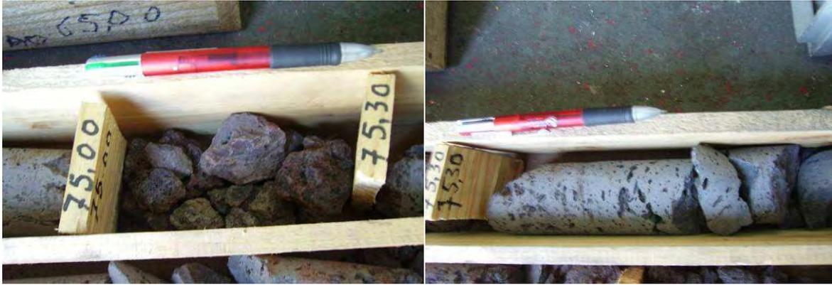
Fig. 67 – Brecha da secção dos 75,00 a 75,30 m de profundidade (à esquerda); Traquibasaltos muito poroso da secção dos 75,30 a 75,10 m de profundidade (à direita)
