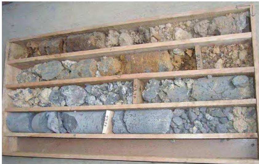
Fig. 15 – Conjunto das litologias atravessadas – 6º tabuleiro (profundidade final = 46,40 m)
