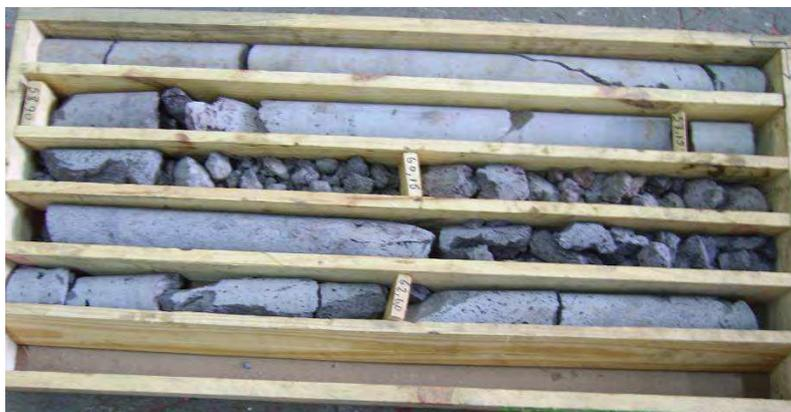
Fig. 147 – Conjunto das litologias atravessadas – 10º tabuleiro (profundidade final = 63,15 m)
