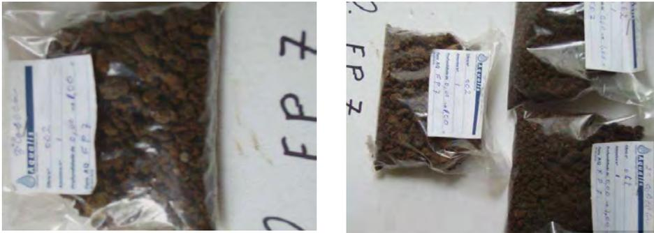
Fig. 111 – Amostra representativa das profundidades 0 a 1 m (à esquerda) e 1 a 2 m (à direita)
