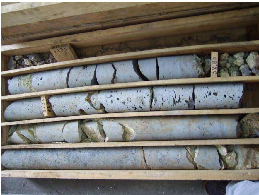
Fig. 107 – Conjunto das litologias atravessadas – 4º tabuleiro (profundidade final = 60,35 m)
