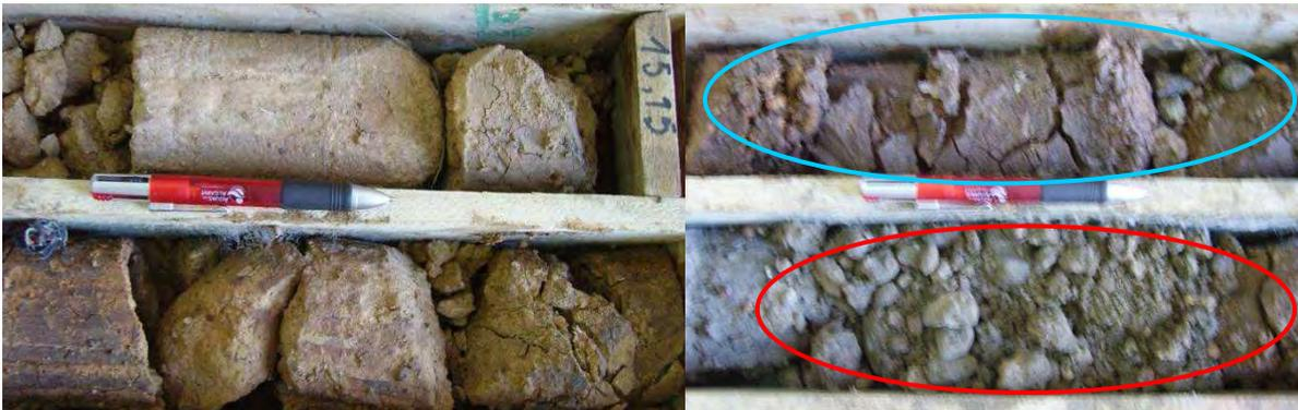
Fig. 123 – Argila arenosa do troço 1 (à esquerda e círculo azul à direita) e zona de material brechóide argilificado do troço 2 (à direita, círculo vermelho) da secção dos 15,15 a 16,85 m de profundidade
