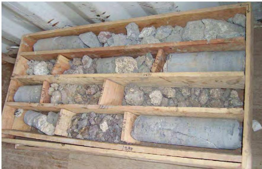
Fig. 11 – Conjunto das litologias atravessadas – 2º tabuleiro (profundidade final = 22,25 m)
