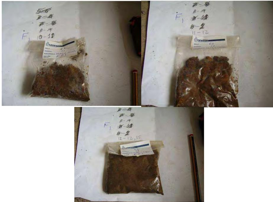
Fig. 6 – Amostra representativa das profundidades 10 a 11 m (à esquerda, cima), 11 a 12 m (à direita, cima) e 12 a 12,85 m (em baixo)
