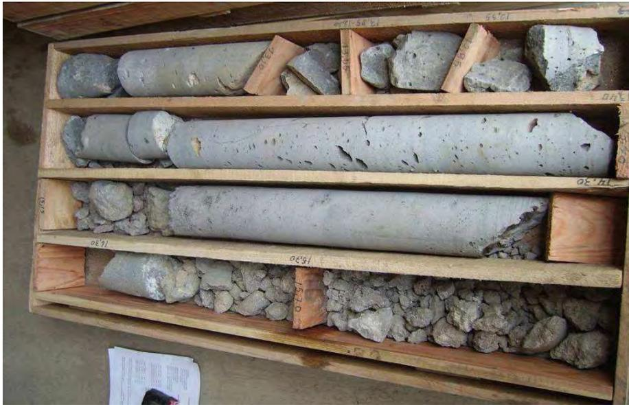
Fig. 9 – Conjunto das litologias atravessadas – 1º tabuleiro (profundidade final = 16,30 m)
