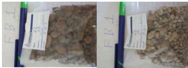
Fig. 37 – Amostra representativa das profundidades 12 a 13 m (à esquerda) e 13 a 14 m (à direita)
