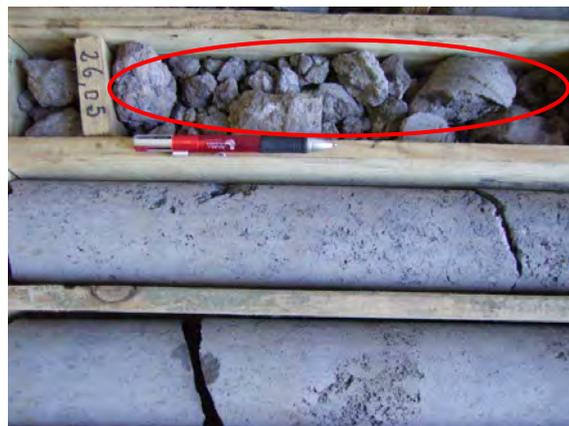
Fig. 130 – Brecha da secção dos 25,25 a 26,05 m de profundidade (círculo vermelho) e traquibasalto do troço 2 da secção dos 26,05 a 27,15 m de profundidade
