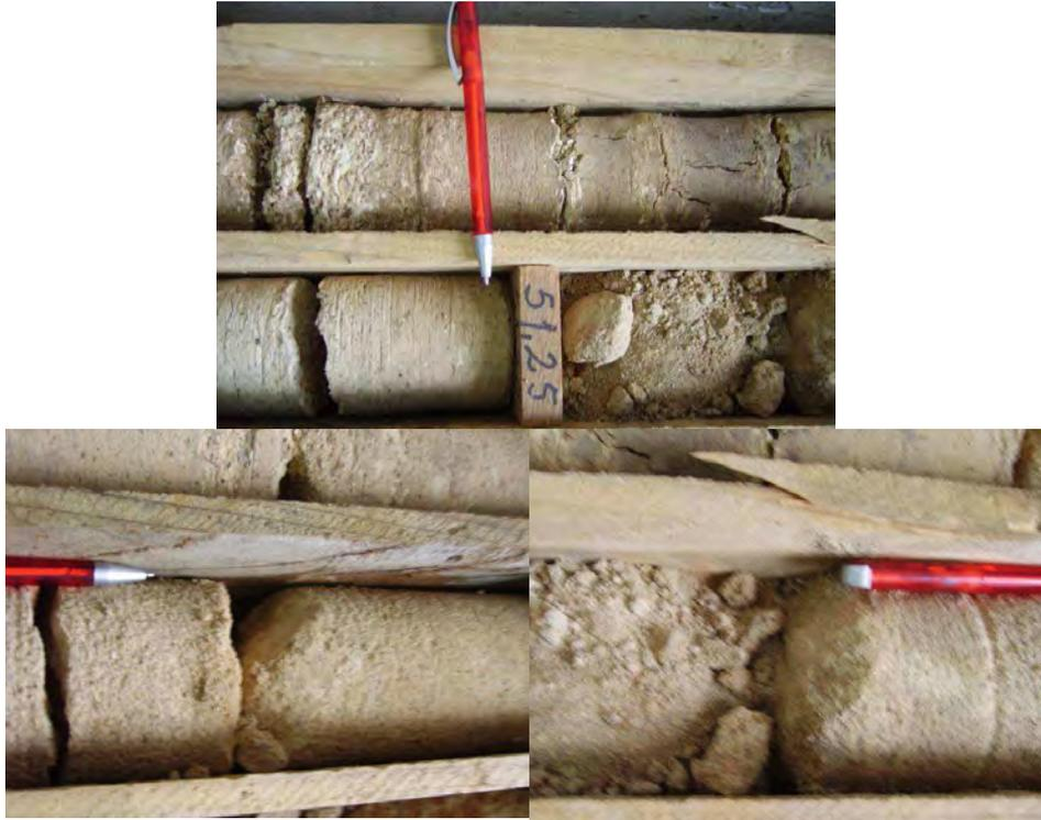
Fig. 101 – Argila arenosa do troço 1 (em cima) a argila arenosa/areia argilosa do troço 2 (em baixo) da secção dos 50,00 a 51,25 m de profundidade
