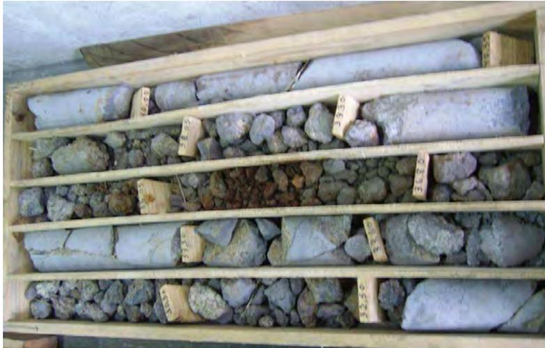
Fig. 75 – Conjunto das litologias atravessadas – 2º tabuleiro (profundidade final = 40,55 m)
