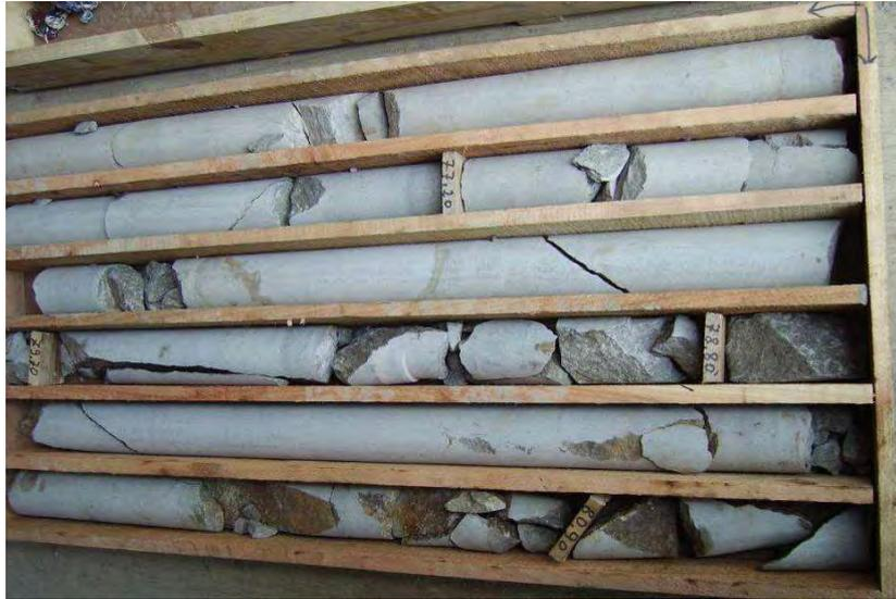
Fig. 27 – Conjunto das litologias atravessadas – 11º tabuleiro (profundidade final > 80,90 m)
