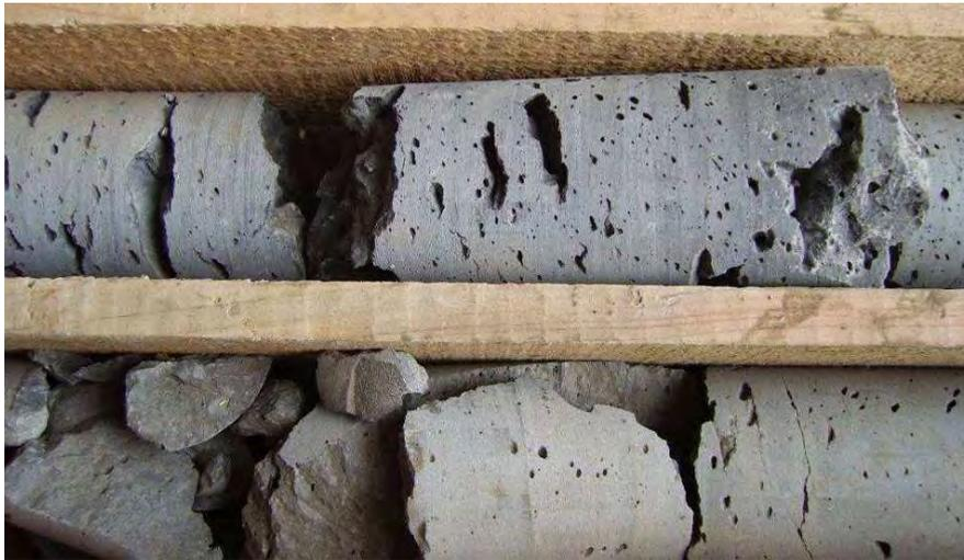
Fig. 22 – Macroporos no troço 2 da secção dos 58,20 a 59,20 m de profundidade
