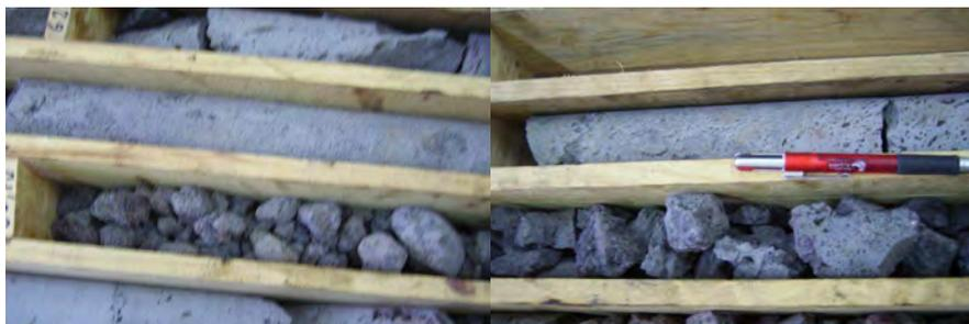
Fig. 146 – Brecha do troço 1 (à esquerda) e brecha do troço 2 (à direita) da secção dos 60,15 a 62,60 m de profundidade
