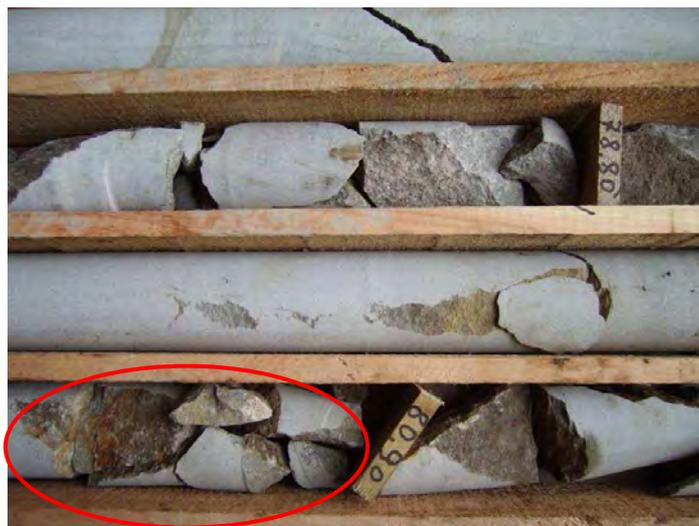
Fig. 28 – Material lávico muito fracturado do troço 1 (círculo vermelho) da secção dos 80,90 a 82,60 m de profundidade
