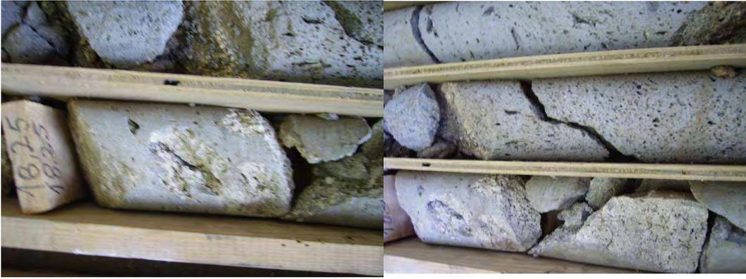
Fig. 45 – Traquibasaltos da secção dos 18,25 a 21,05 m de profundidade (esquerda – topo da secção; direita – zona intermédia da secção)
