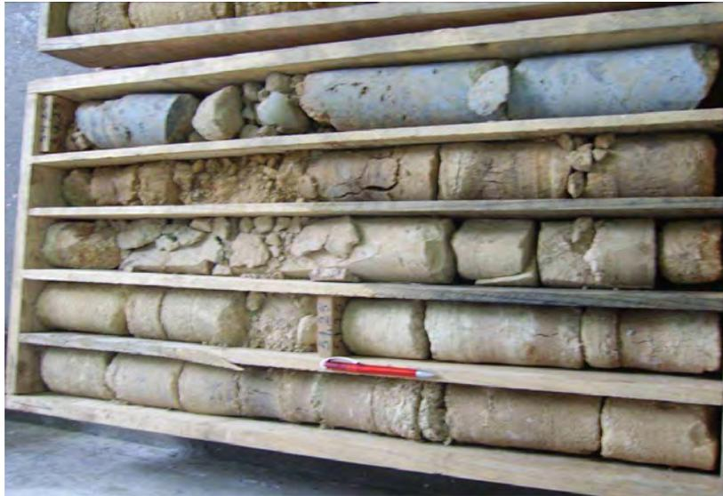
Fig. 104 – Conjunto das litologias atravessadas – 3º tabuleiro (profundidade final = 55,15 m)
