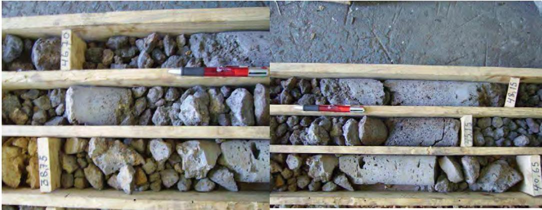
Fig. 140 – Brechas da secção dos 38,75 a 40,65 m de profundidade
