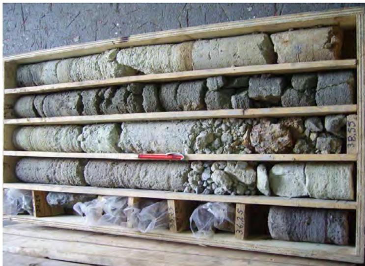
Fig. 96 – Conjunto das litologias atravessadas – 1º tabuleiro (profundidade final = 40,55 m)
