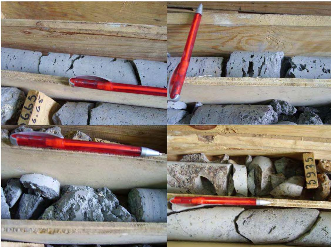
Fig. 79 – Traquibasilto da secção dos 56,65 a 59,35 m de profundidade
