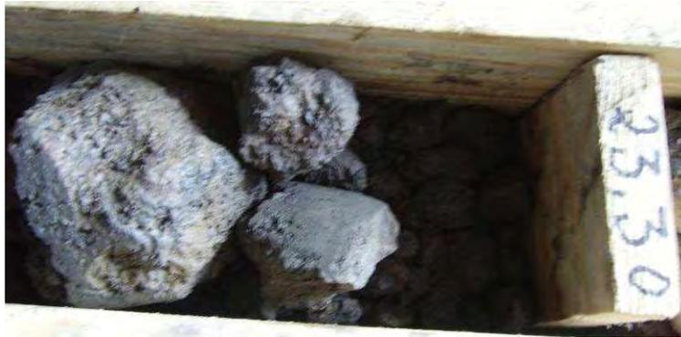
Fig. 127 – Brechas da secção dos 23,30 a 23,50 m de profundidade
