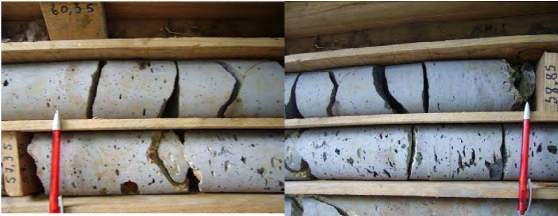
Fig. 106 – Traquibasalto da secção dos 57,35 a 58,85 m de profundidade
