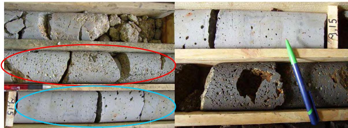
Fig. 118 – Traquibasilto muito poroso (à esquerda, círculo vermelho), com macroporos (à direita) e muito pouco poroso (à esquerda círculo azul) do troço 2 da secção dos 7,15 a 9,15 m de profundidade
