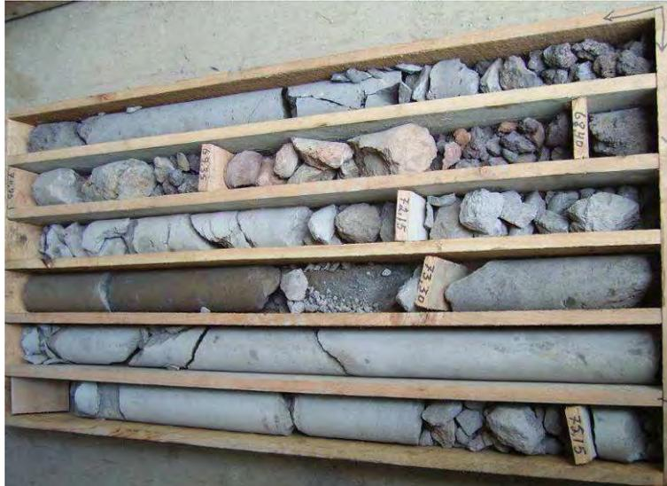
Fig. 26 – Conjunto das litologias atravessadas – 10º tabuleiro (profundidade final = 75,90 m)
