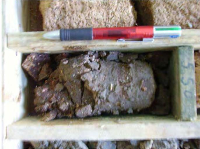
Fig. 116 – Argila arenosa anegrada do troço 1 da secção dos 5,50 a 7,15 m de profundidade
