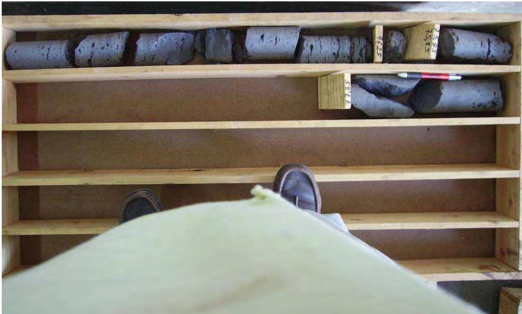
Fig. 70 – Conjunto das litologias atravessadas – 10º tabuleiro (profundidade final = 77,35 m)
