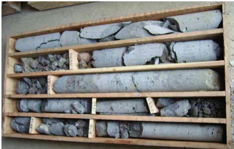
Fig. 16 – Conjunto das litologias atravessadas – 7º tabuleiro (profundidade final = 51,65 m)
