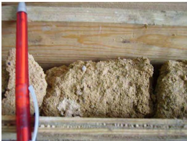
Fig. 97 – Argila arenosa/arenito de cimento argiloso da secção dos 40,55 a 41,55 m de profundidade
