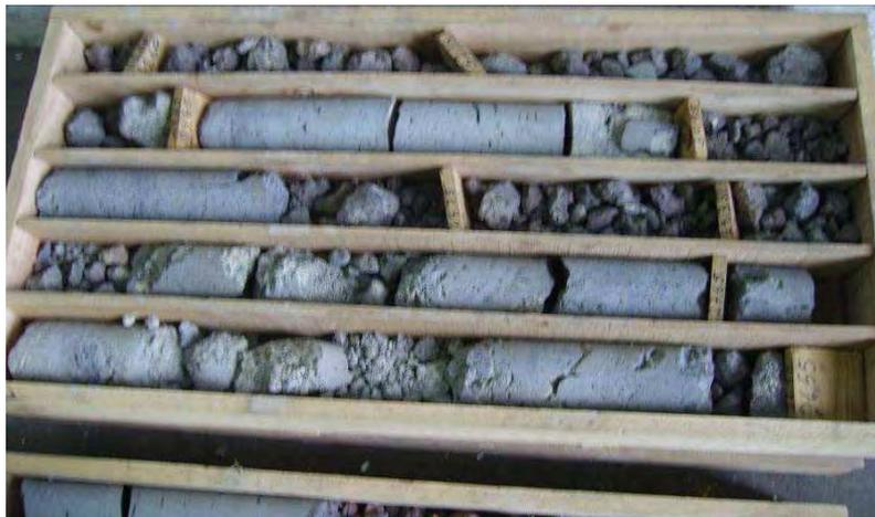
Fig. 50 – Conjunto das litologias atravessadas – 2º tabuleiro (profundidade final = 32,70 m)
