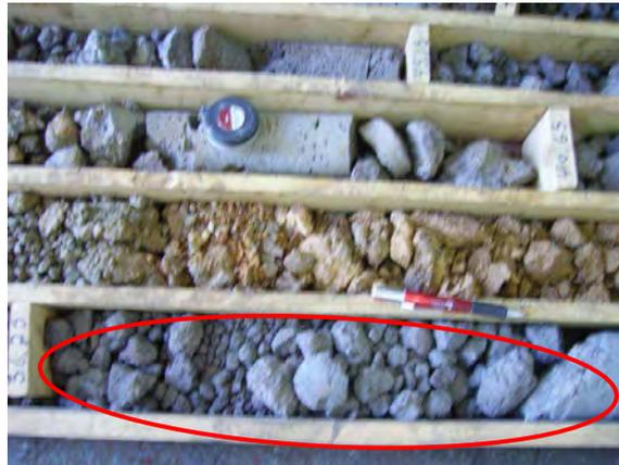
Fig. 138 – Brecha (círculo vermelho) da secção dos 36,75 a 37,70 m de profundidade
