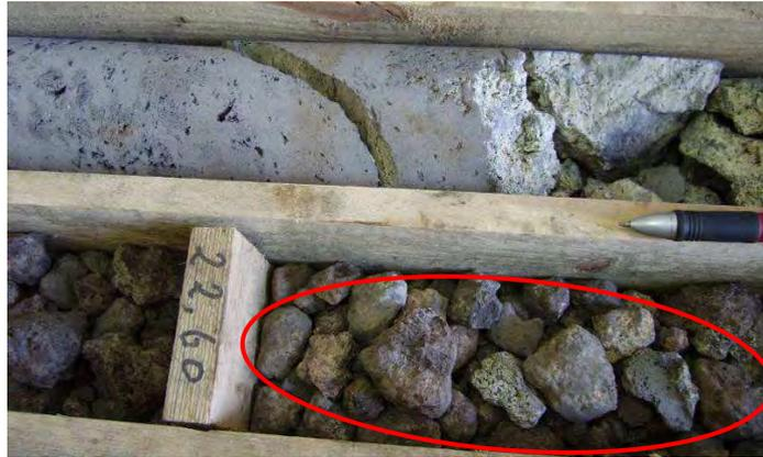
Fig. 126 – Brechas (círculo vermelho) da secção dos 22,10 a 22,60 m de profundidade
