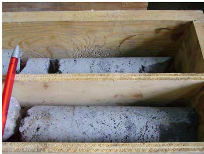
Fig. 77 – Basalto poroso a muito poroso do troço 2 da secção dos 48,25 a 50,90 de profundidade
