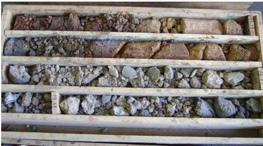
Fig. 124 – Conjunto das litologias atravessadas – 4º tabuleiro (profundidade final = 19,65 m)
