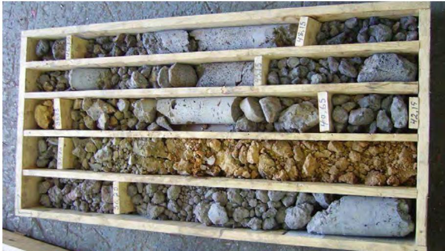
Fig. 142 – Conjunto das litologias atravessadas – 9º tabuleiro (profundidade final = 48,30 m)
