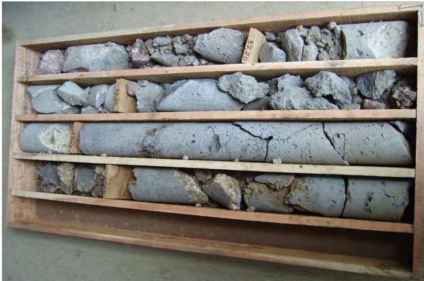
Fig. 14 – Conjunto das litologias atravessadas – 5º tabuleiro (profundidade final = 40,65 m)
