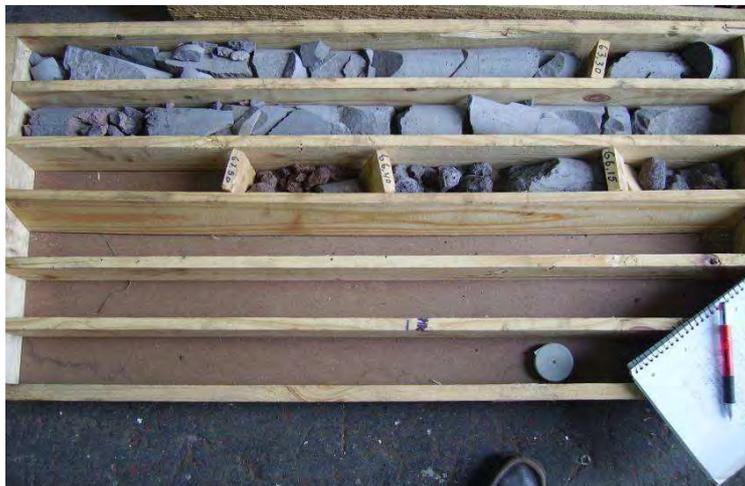
Fig. 149 – Conjunto das litologias atravessadas – 11º tabuleiro (profundidade final = 67,50 m)
