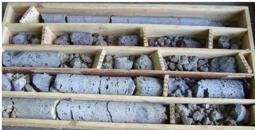
Fig. 63 – Conjunto das litologias atravessadas – 7º tabuleiro (profundidade final = 65,00 m)
