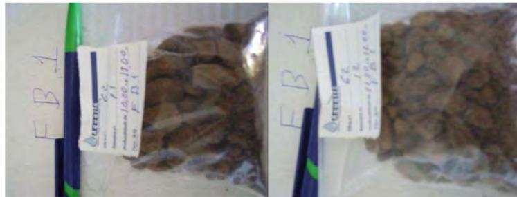
Fig. 36 – Amostra representativa das profundidades 10 a 11 m (à esquerda) e 11 a 12 m (à direita)
