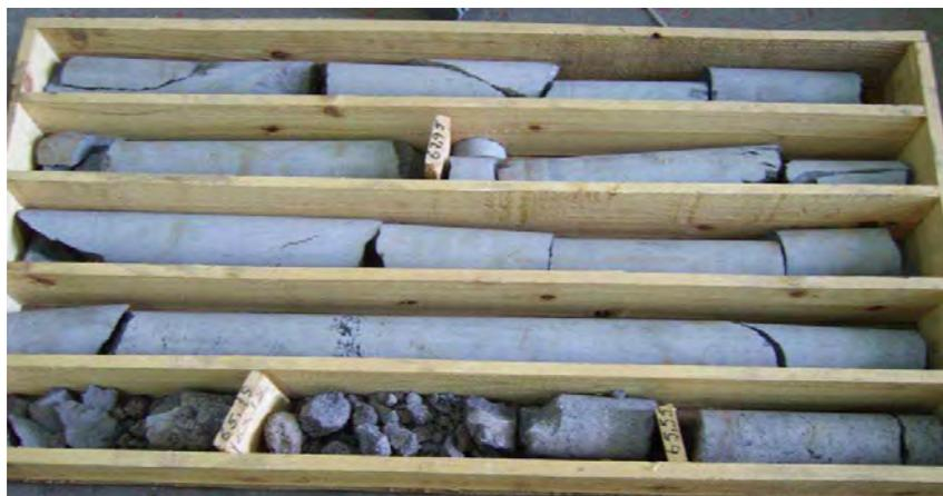
Fig. 65 – Conjunto das litologias atravessadas – 8º tabuleiro (profundidade final = 69,50 m)
