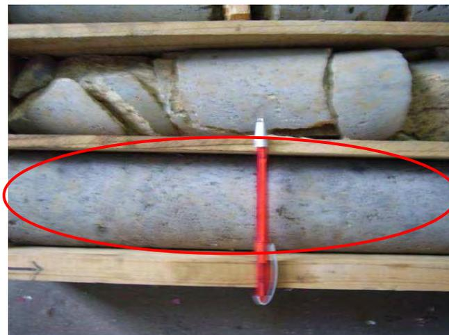
Fig. 105 – Traquibasalto pouco fracturado (círculo vermelho) da secção dos 55,15 a 57,35 m de profundidade
