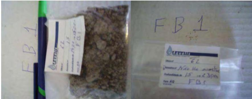
Fig. 38 – Amostra representativa das profundidades 14 a 15 m (à esquerda) e 15 a 23 m (à direita)
