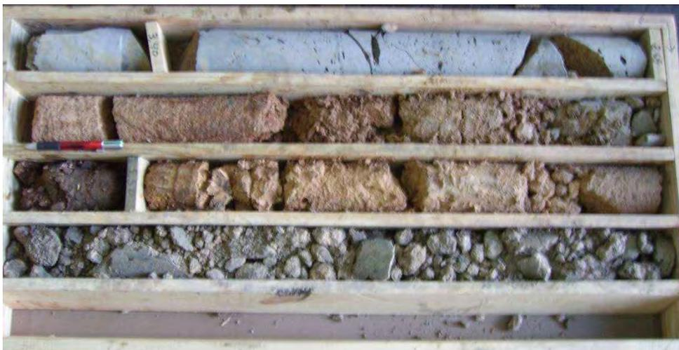
Fig. 117 – Conjunto das litologias atravessadas – 1º tabuleiro (profundidade final = 7,15 m)
