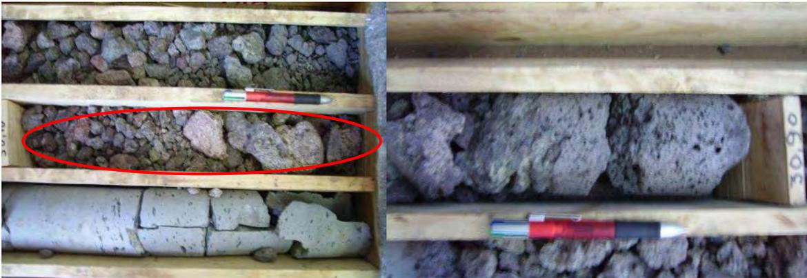
Fig. 133 – Brecha do troço 1 (à esquerda, círculo vermelho) e lavas basálticas porosas do troço 2 (à direita) da secção dos 30,15 a 30,90 m de profundidade
