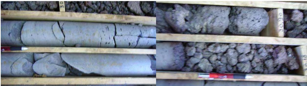
Fig. 132 – Traquibasalto do troço 1 (à esquerda) e brecha do troço 2 (à direita) da secção dos 28,65 a 30,15 m de profundidade
