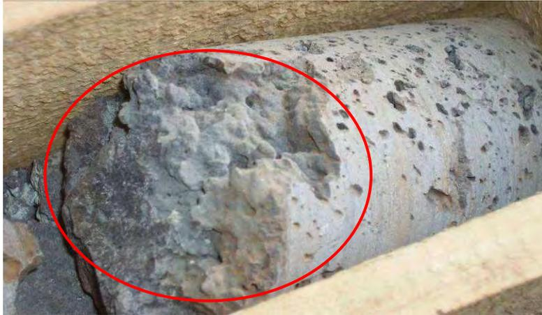
Fig. 19 – Fractura irregular, ruiniforme (possível macroporo) do troço 2 da secção dos 52,90 a 53,80 m
