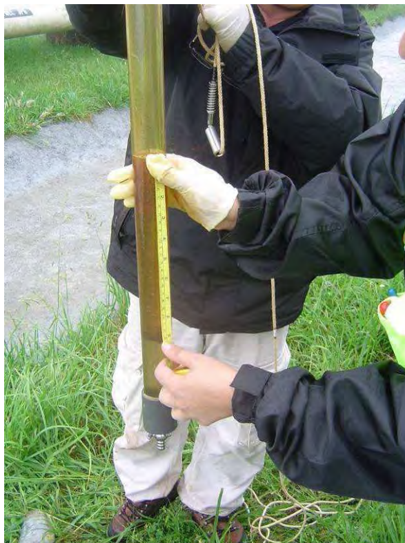
Fig. 109 – Fotografia de LNAPL sobrenadante na água do ponto MW08
