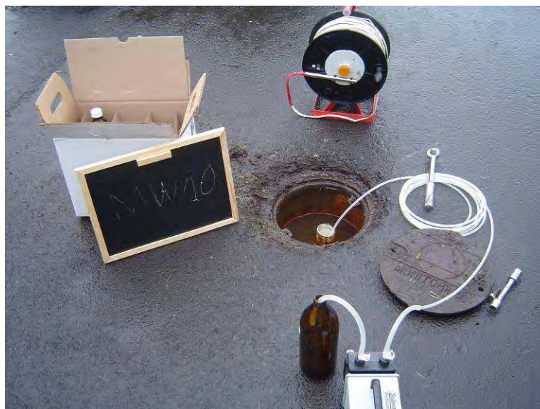
Fig. 108 – Recolha de amostra com recurso a uma bomba peristáltica de baixo caudal
