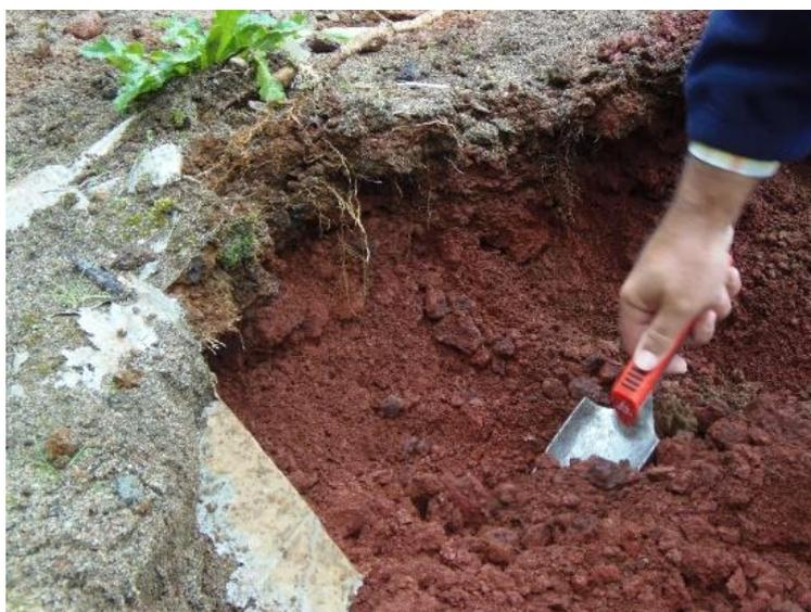
**Figura 19:** Aspecto do perfil com folha de plástico entre a areia e o substrato de “bagacina”
